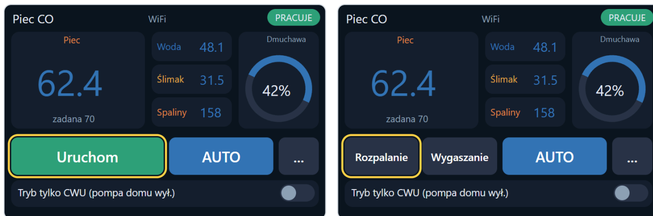
Rys. 27. Ekran główny: kocioł na ekogroszek (Uruchom) i na pellet (Rozpalanie, Wygaszanie).
