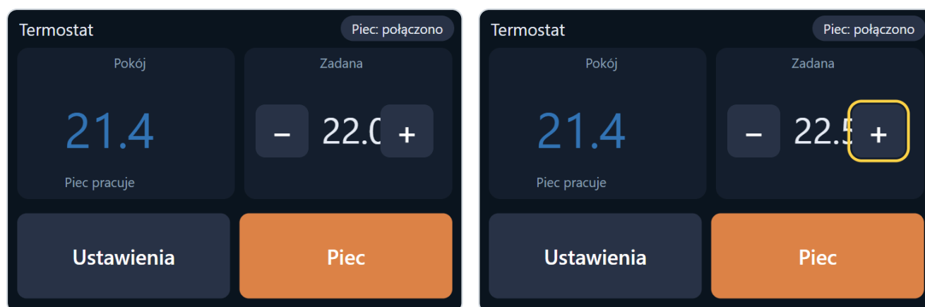
Rys. 29. Ekran pokoju: temperatura, zadana, regulacja wg pokoju, temperatury pieca.
